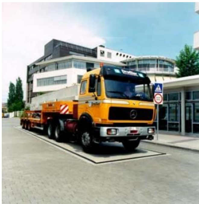
Obr. 14 Silniční váha Schenck. Využívá se např. v úpravně ČSM k vážení hlušiny pro rekultivační účely.
