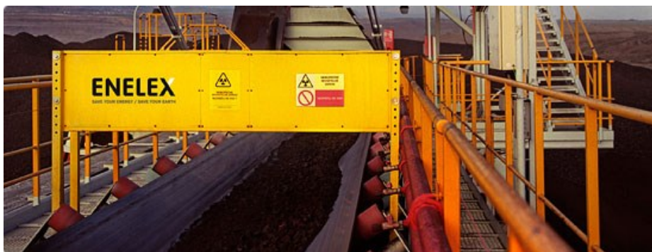
Obr. 30 Kontinuální popeloměr Enelex Chvaletice
