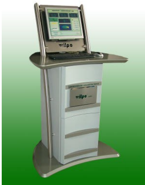
Obr. 12 Rychloanalyzátor Wilpo pro rychlou analýzu obsahu popela, vody, síry a výhřevnosti, používaný v OKD, výrobce Polsko (Katowice)
